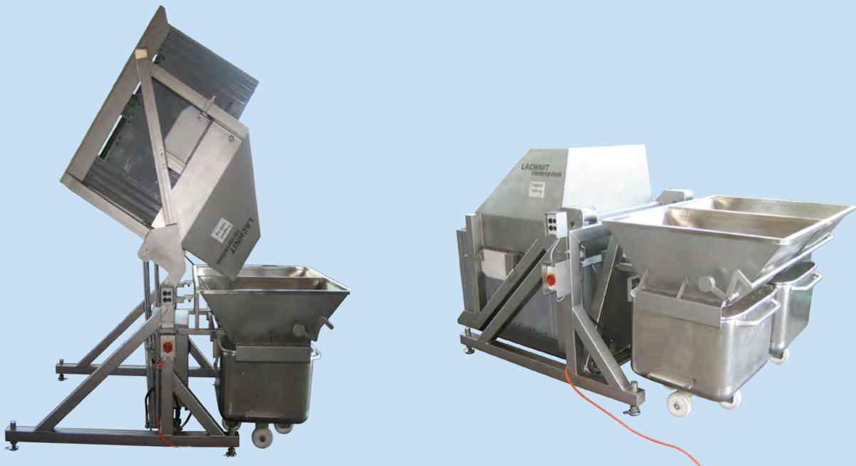
Aufnahmen für verschiedene Behälter sind möglich, die in einen oder zwei Beschickungswagen oder andere Behälter entleert werden.
