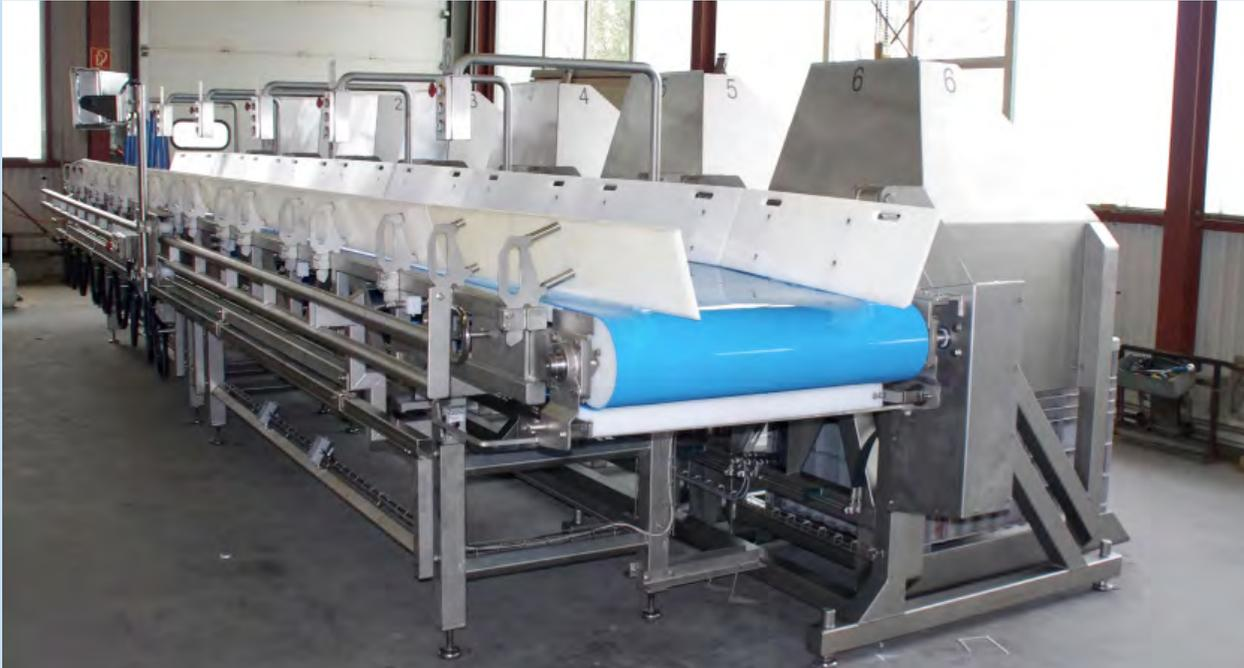
Nach Abarbeiten der vorgegebenen Rezeptur wird die komplette Charge in den linken oder rechten Transportbehälter durch ein Förderband gebracht.
