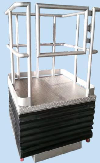
Hier ein Hubtisch für die Personenmitfahrt mit umlaufendem Faltenbalg, der als Klemmschutz für die Schere dient und Mensch und Maschine schützt.
