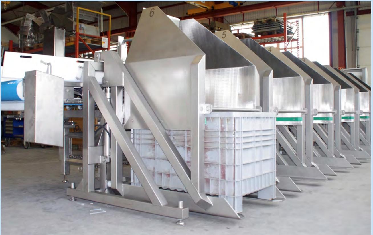
Für das Kommissionieren von Rezepten in der Lebensmittelindustrie bieten wir Chargieranlagen in Edelstahlausführung an. Die flexibel planbaren Anlagen sind geeignet für die Verwiegung verschiedener Produkte aus mehreren Großbehältern sowie eine exakte Chargenzusammenstellung nach vorgegebenen Rezepturen. Ihr Einsatz ist deutlich kostengünstiger und hygienischer als einzelne Kippgeräte.
