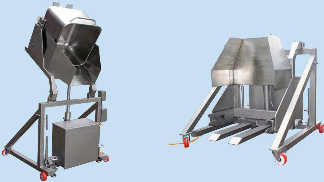
Bei unterschiedlich hohen Behältern passt sich die Rückhalteeinrichtung automatisch an.
