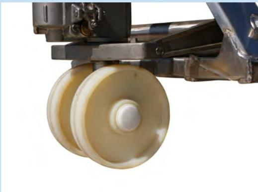
Die Lenkräder aus Polyamid sind widerstandsfähig gegen aggressive Medien.
