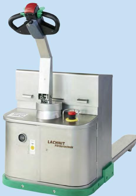
Bei Mehrschichtbetrieb kann die Batterie seitlich gewechselt werden.
