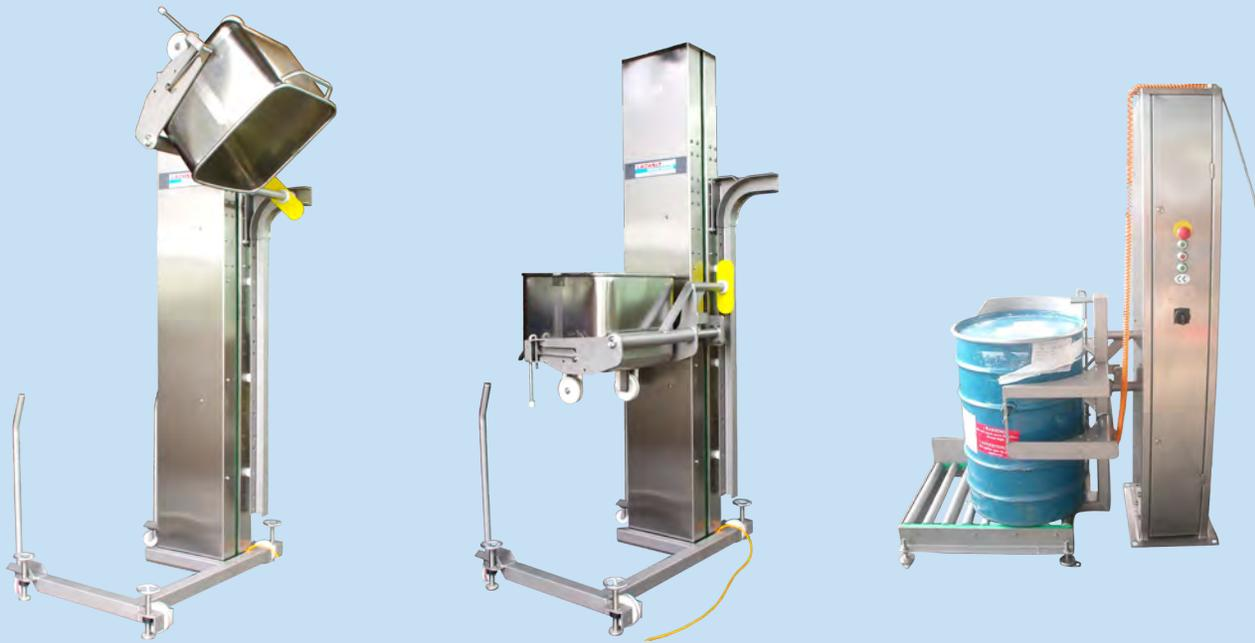
Obleich wir die Hebe-Kippmaschine Typ 300 für die Aufnahme von Normbeschickungswagen optimiert haben, kann der Anwender damit auch beliebige andere Behälter handhaben – etwa Fässer, Teigtöpfe oder Kanister. Optional kann ein Fahrwerk mit Feststelspindel angebracht werden.
