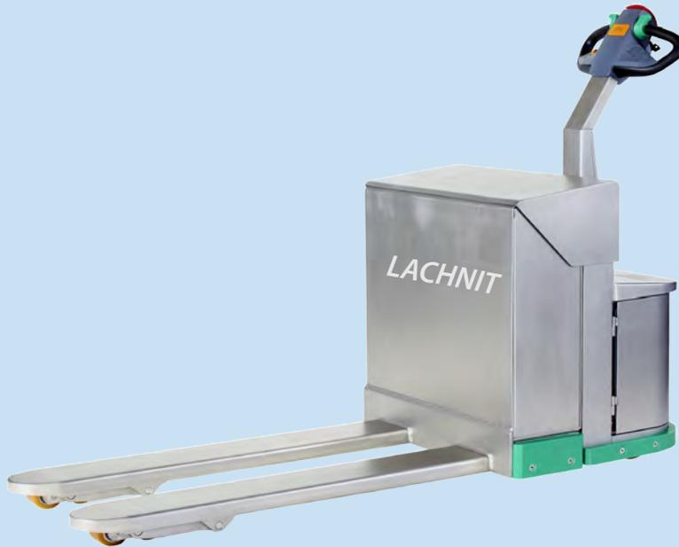
Für den Einsatz in sensiblen Bereichen oder auch Umgebungen mit hoher Luftfeuchtigkeit sind alle wichtigen Komponenten mit einem wasserdichten Edelstahlgehäuse ummantelt, das Schutzart IP66 erfüllt.
