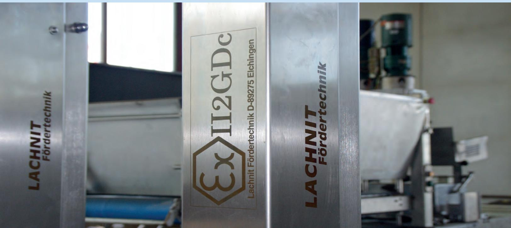
Der Einsatz von Förder- und Handhabungstechnik in Ex-Bereichen und Reinräumen unterliegt strengen gesetzlichen Regeln und Vorschriften. Flurförderzeuge, Lifte und Hubwagen müssen hierfür speziell konstruiert und mit geeigneten Materialien gefertigt sein.
