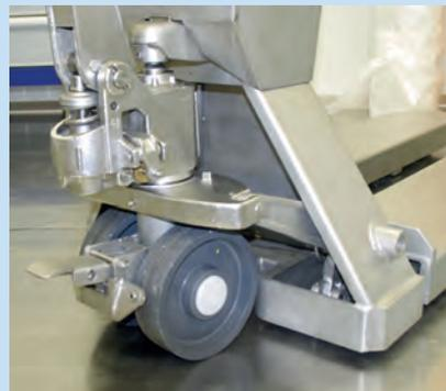
Tandem-Gabelrollen aus Polyurethan ermöglichen geräuscharmes Fahren.
