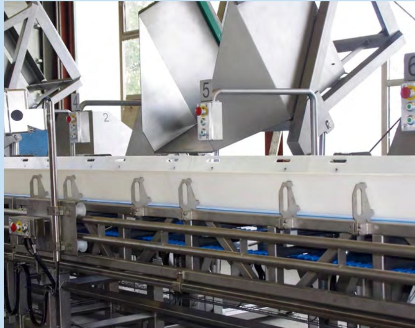
An jeder Kippmaschine kann der Behälter stufenlos hochgekippt werden. Am Sammelband ist das Wiegeterminal befestigt, welches seitlich zu jeder Kippstation verschoben werden kann.
